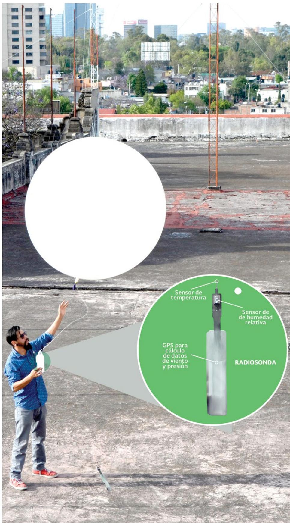
Lanzamiento de radiosonda.
