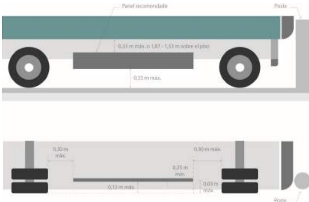
La parte inferior del salvaguarda debe estar a una altura de 0.35 m sobre la superficie de rodadura y la parte superior a 0.35 m de la plataforma del camión. Si no es posible cumplir con la cota en la parte superior del dispositivo, la parte superior de éste debe quedar entre 1.00 a 1.50 m sobre el nivel del arroyo vial.
